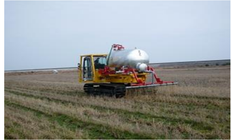
システム工学（メタン発酵消化液の散布実験）
